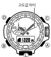
기준 고도값을 지정하였을 경우, 고도 측정 시 초침이 기준 고도값과 측정된 고도값의 차이를 표시합니다. 이 차이값은 고도가 자동으로 측정될 때마다 갱신됩니다.
